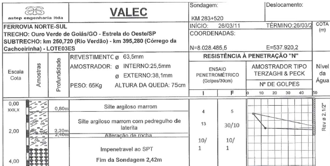
Figura 5. Perfil da sondagem na Macroárea 4.
