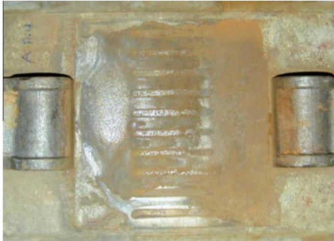
Figura 10 — Chapa de aço cobrindo o assento do trilho após 10 milhões de ciclos a uma taxa de 2,5 ciclos por segundo (Fonte: Peters, 2004)
