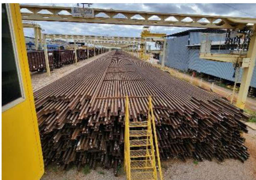
Fotografia 38 – Estoque de trilhos longos soldados (TLS).
